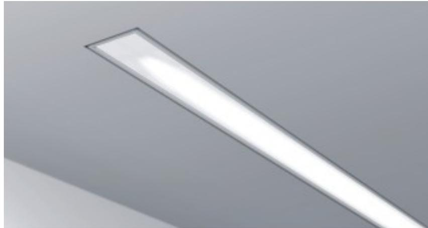
Als Alternative zur vorgenannten Anputzmontage ist die Einbaumontage mit Schattenfuge empfehlenswert. Eine sauber erstellte Deckenöffnung ist leicht durch Gipsfertigbauteile oder auch durch Anputzschienen zu erzielen. Auch sind verschiedenste Betoneinbaugeschäule für unsere Lichtlinien lieferbar.
