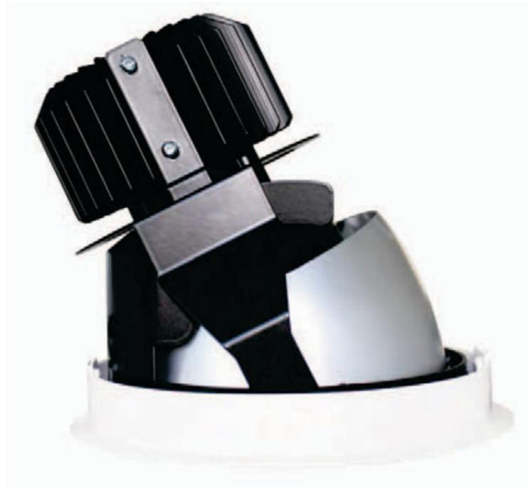
Diese LED-Strahler können ganz unterschiedliche Aufgaben erfüllen – von der blendfreien Allgemeinbeleuchtung bis zu variablen und punktgenauen Lichtakzenten. Die Strahler sind um 350° drehbar und zwischen 30° und 50° schwenkbar. Die Produktfamilie wurde als flexibles Lichtwerkzeug konzipiert. Sie umfasst in einheitlichem Leuchtendesign drei Varianten, zwei Größen und fünf Abstrahlcharakteristiken.
