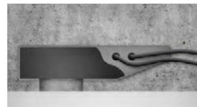
► Der rahmenlose Einbau in gegossene Betondecken kann durch speziell entwickelte Betoneingießgehäuse realisiert werden. Durch ein variables Kernelement ist dies auch bei Sichtbetondecken möglich.
