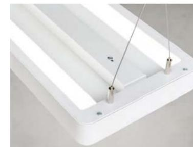
Leuchte direkt/indirekt strahlend, bestückt mit LED-Arrays in COB (Chip-on-board) Technologie. Über 100 lm/W und überragend lange Lebensdauer. L90/B10 – 50000 h, 3 Step MacAdam, CRI > 84.
